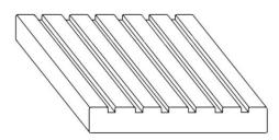
которая крепится к доске или лаге саморезом. Если торцевая планка закрывает торец доски и крепится основанию террасы (лаге), необходимо оставить зазор между торцом доски и планкой не менее 5мм для компенсации температурных расширений доски. Торцевую планку рекомендуется устанавливать шлифованной стороной наружу (поверхность с фактурой «вельвет»):
